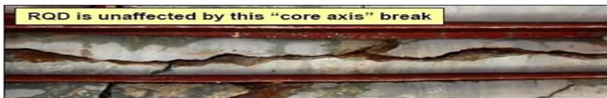
Rasm 14. Birinchi toifa darzining misoli
