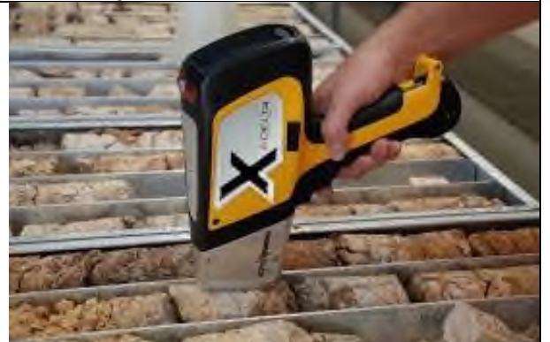
NITON kabi rentgen-fluorissent uskuna bilan o'lchash
