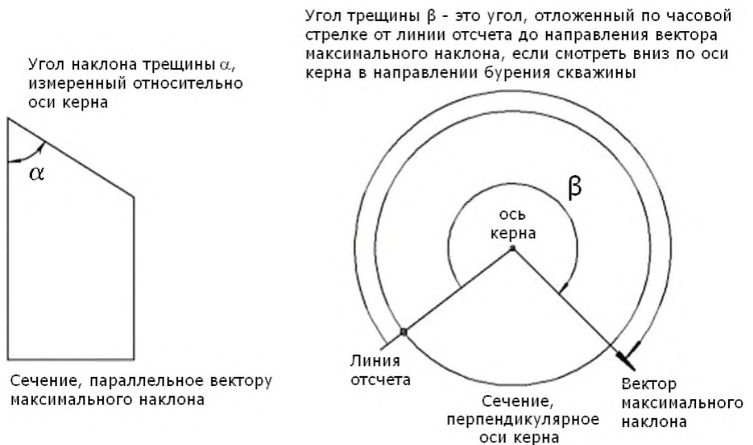
Rasm 19. Yo‘naltirilgan kerndagi alfa va beta burchaklarni aniqlash
