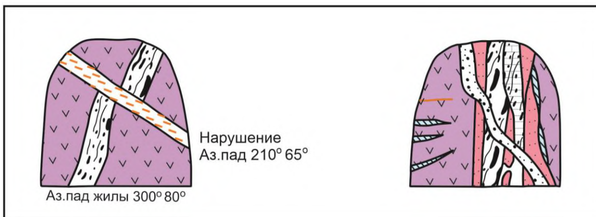
Рис.21. Примеры зарисовок забоев горизонтальных горных выработок. Примечание: условные обозначения приводятся на 1 листе журнала.
