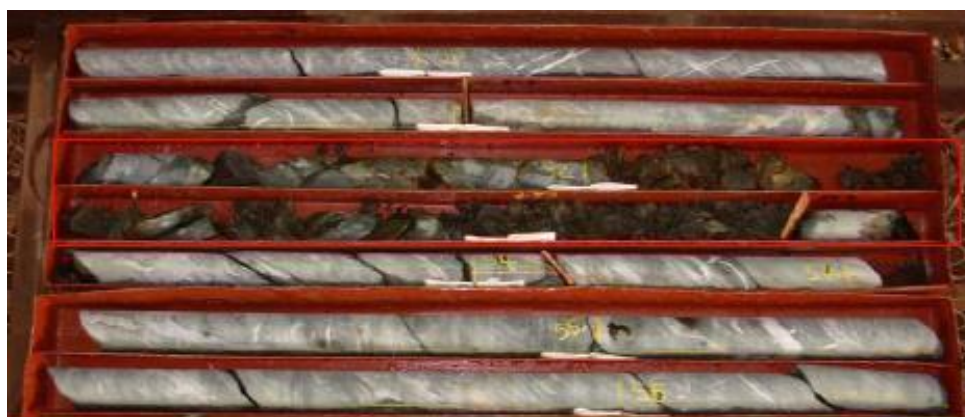
Рис. 9. Интерпретация зоны дробления
