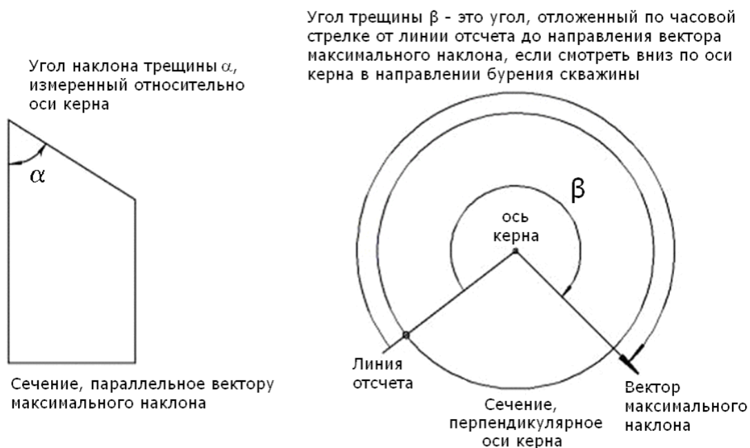
Рис. 19. Определение углов Альфа и Бета при ориентированном керне
