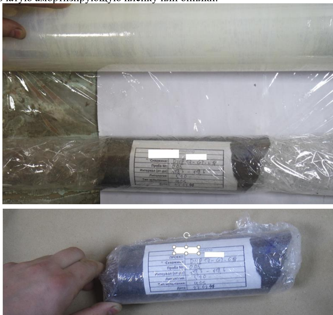
Рис. 22: Упаковка образца в полиэтиленовую пленку
