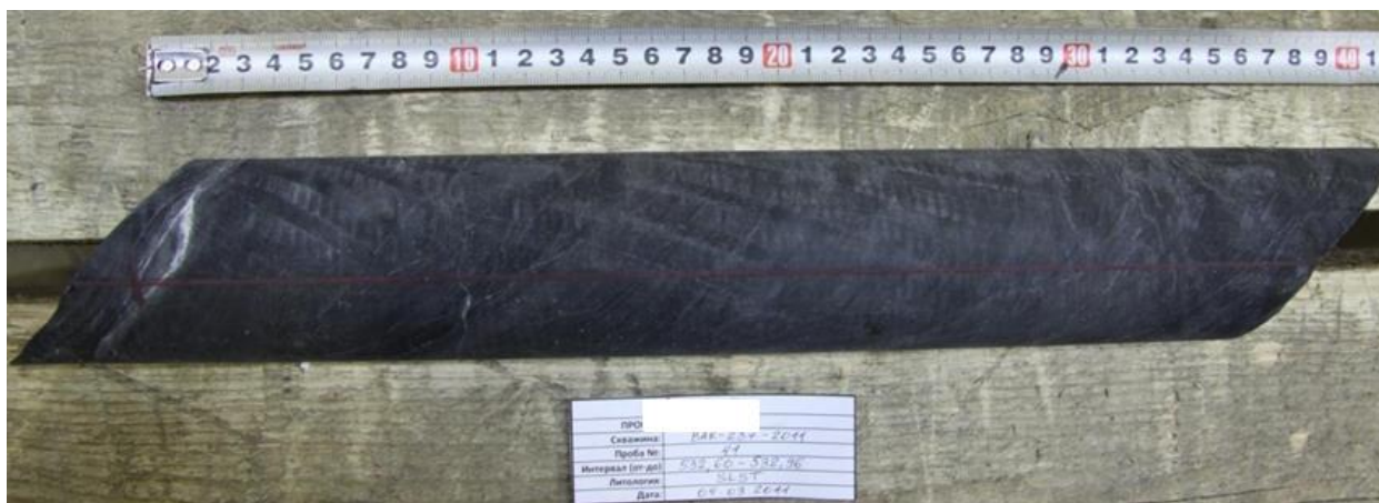
Рис. 20: Пример образцов для испытаний UCS+UTS
