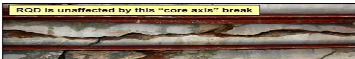
Рис. 10. Пример трещины первой категории
