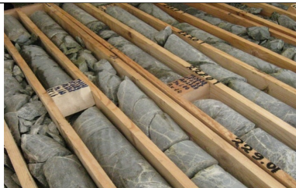
Проверить маркировку проходки
