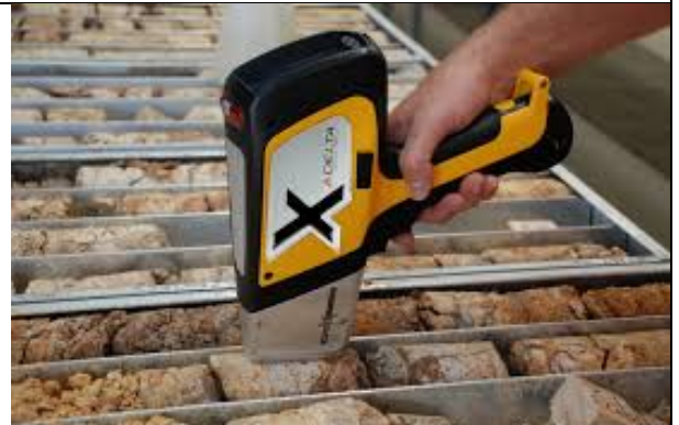
Измерение рентгенно – флуорисцентным оборудованием типа (NITON)
