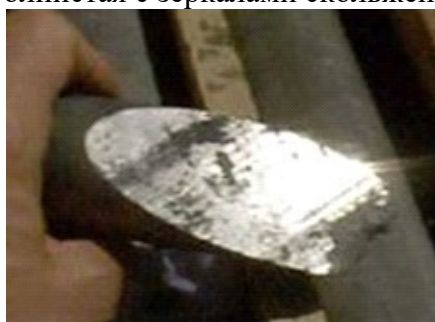
Плоская с зеркалами скольжения / отполированная
