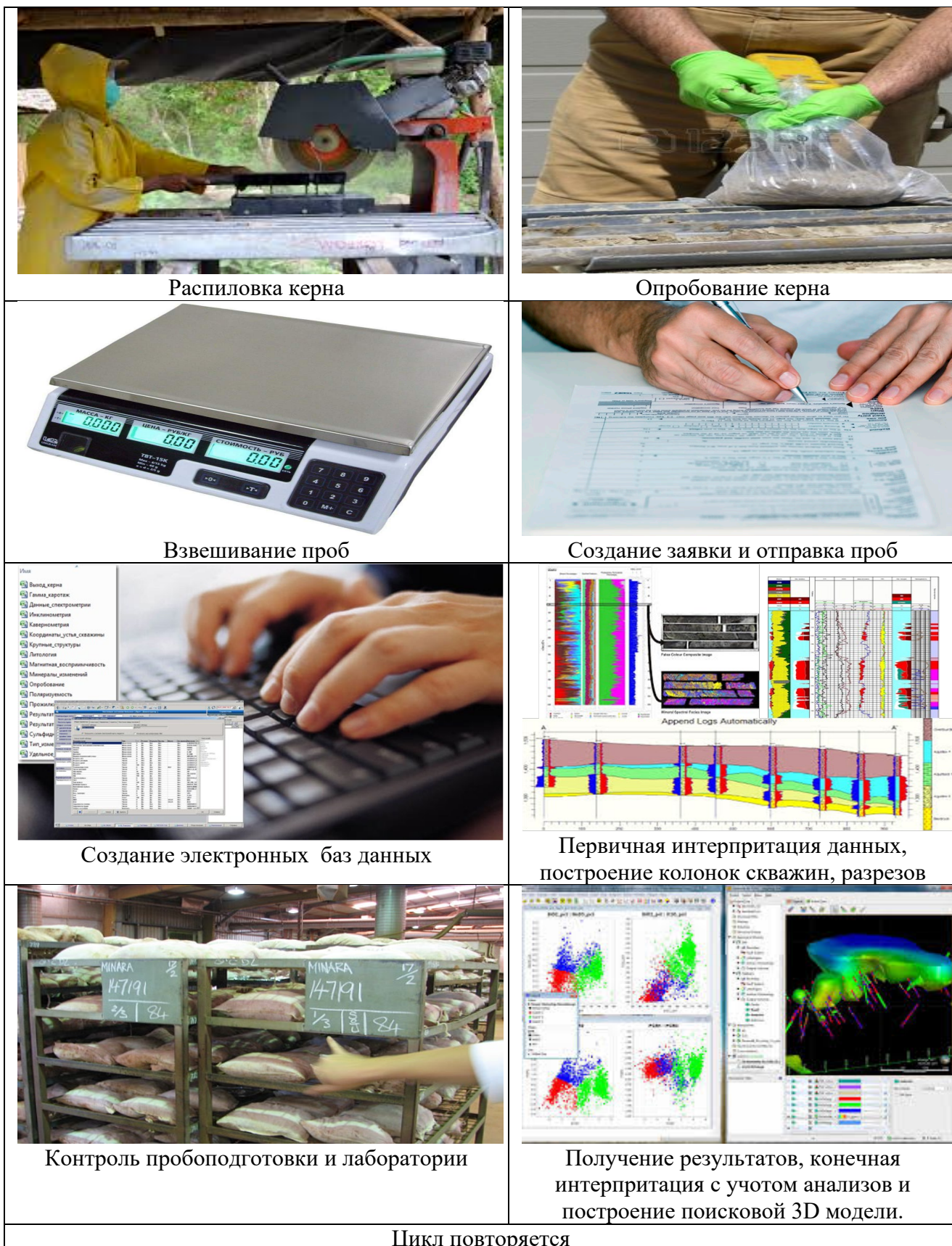
Рис. 1 Цикл работы с керна. Выполняется геологом и бузовикам
