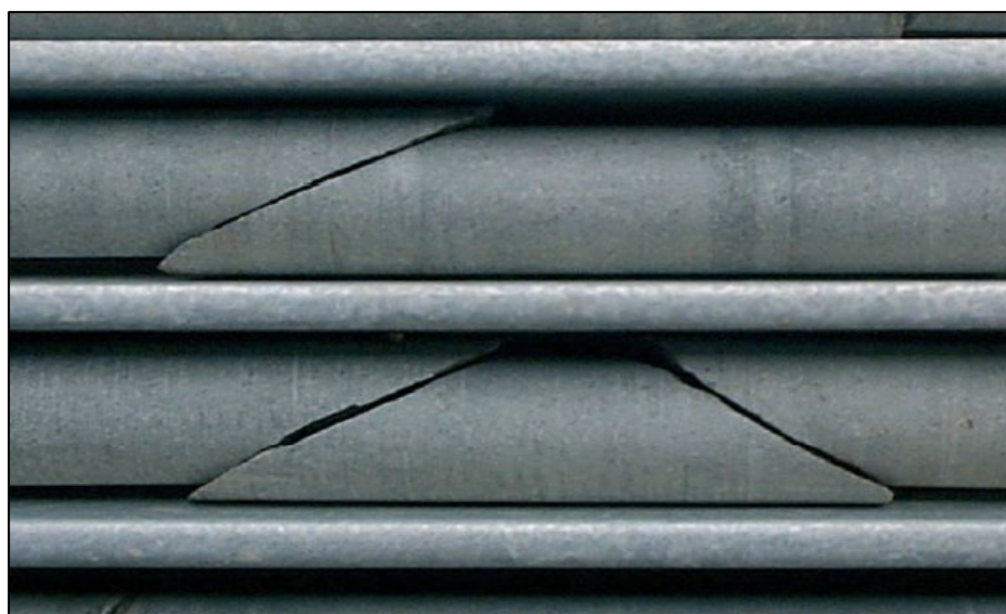
Рис. 13. Пример двух систем трещин с одинаковым углом относительно оси керна, но с разной ориентацией (образуют клин).
