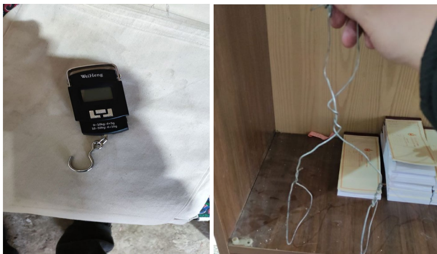
Рис.23. Электронные ручные весы для взвешивания керна, ручное приспособление из алюминиевой проволоки для погружения керна в воду.
