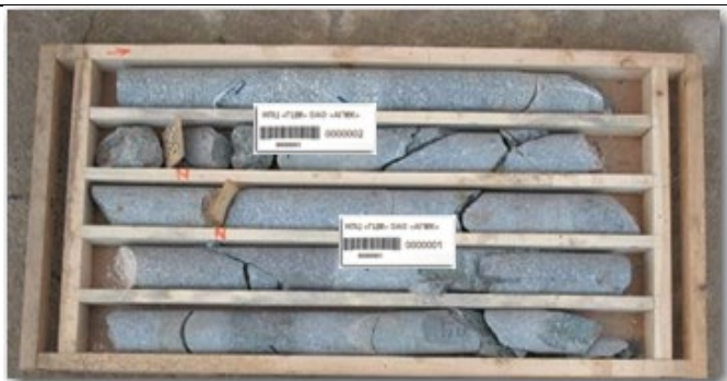
Разметка проб и установка этикеток
