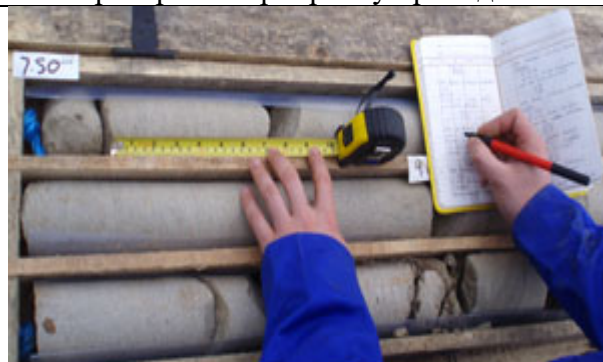
Измерение выхода керна (геотехника)
