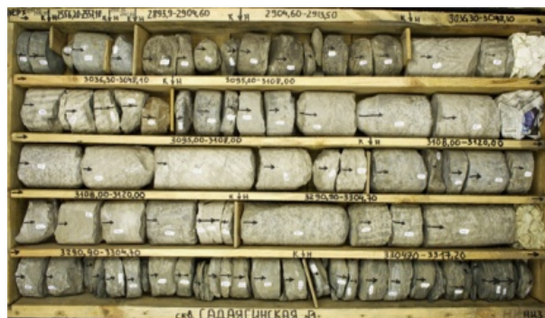
Ориентация и Разметка керна
