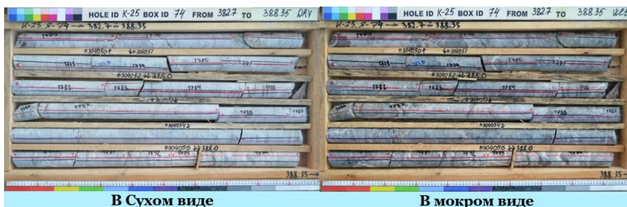
Рис.22. Пример фото керна
