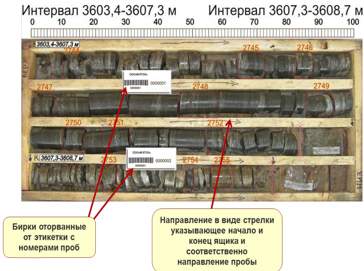
Рис.20. Примеры этикеток для опробования
