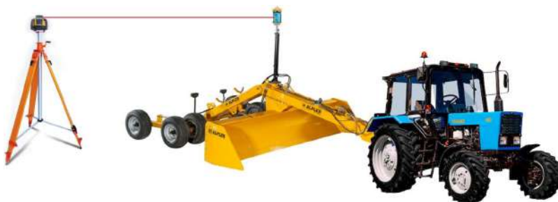
17-расм. Замонавий лазер нивелири билан жиҳозланган ер текислагич
