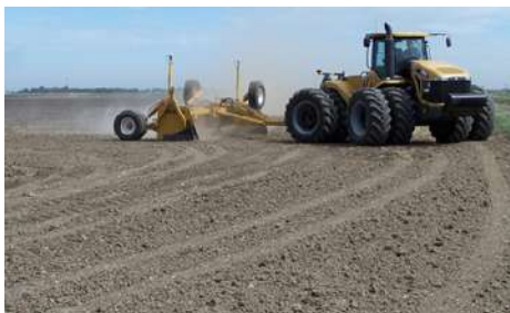
22-расм. Ерларни капитал текислашда фойдаланиладиган лазер қурилмаси билан жиҳозланган техникалар
