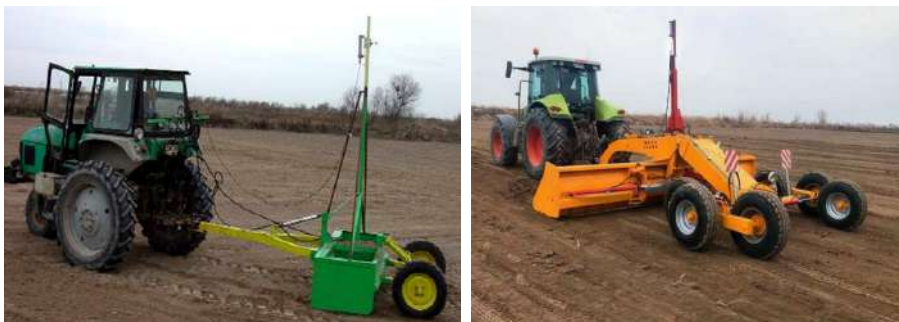
29-расм. Лазер ускунаси билан жиҳозланган техникалар
