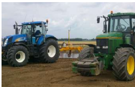
22-расм. Ерларни капитал текислашда фойдаланиладиган лазер қурилмаси билан жиҳозланган техникалар
