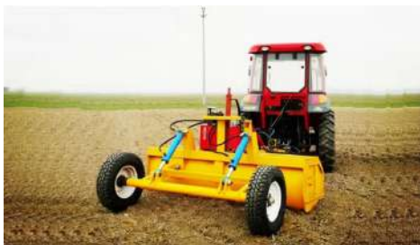
6-а). Лазер ускунаси билан жиҳозланган қисқа базали ер текислагичда якуний (эксплуатацион ер текислашдан кейин) текислаш жараёни
