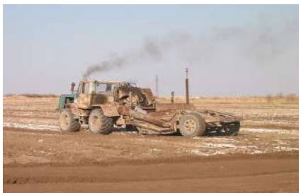
5-а). Гидротиркамали скреперда ерларни текислаш жараёни
