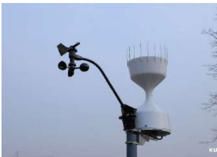
1.2-расм. Шамол тезлигини ўлчаш қурилмаларини ўрнатиш
