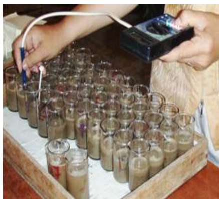
2.4-расм. Электрокондуктомерт ёрдамида тупроқ шўрланишини ўлчаш
