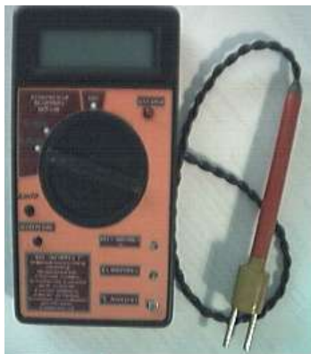
2.4-расм. Электрокондуктомерт ёрдамида тупроқ шўрланишини ўлчаш
