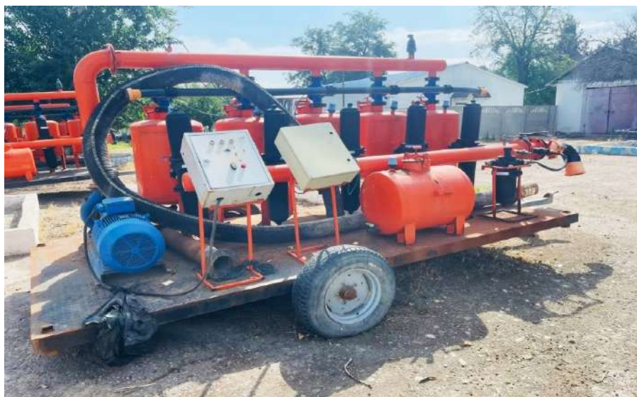
43-расм. Мобил фильтр станцияси
