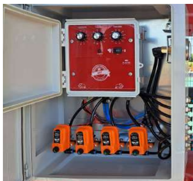
10-расм. Қумли филтрларни ювиш автоматик бошқарув тизими
