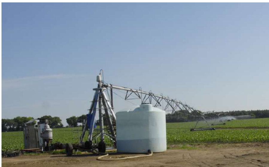
24-расм. Ёмғирлатиб суғориш тизимида ўғитлаш жараёни
