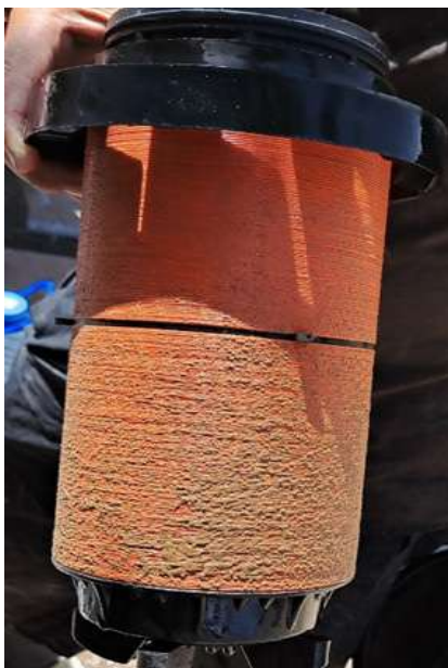
24-расм. Дискли фильтр пластинкаларининг ювишдан аввалги ҳолати
