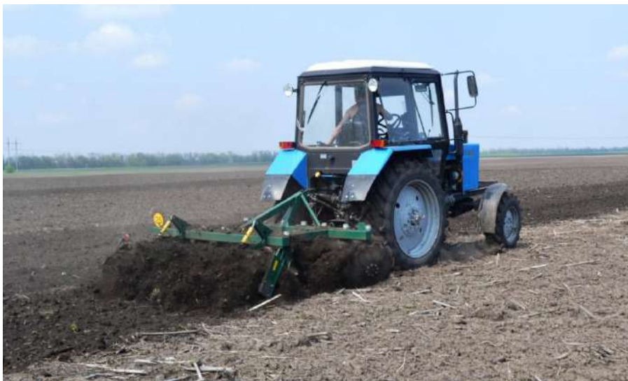
29-расм. Ғалла экиш олди ерга дискли ишлов бериш жараёни
