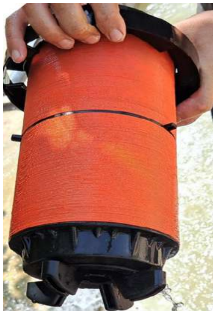
25-расм. Дискли фильтр пластинкаларининг ювилган ҳолати
