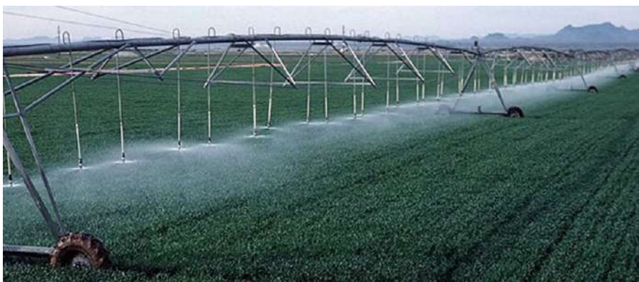
26-расм. Pivot тизими орқали куёғи буғдойни ёмғирлатиб суғориш
