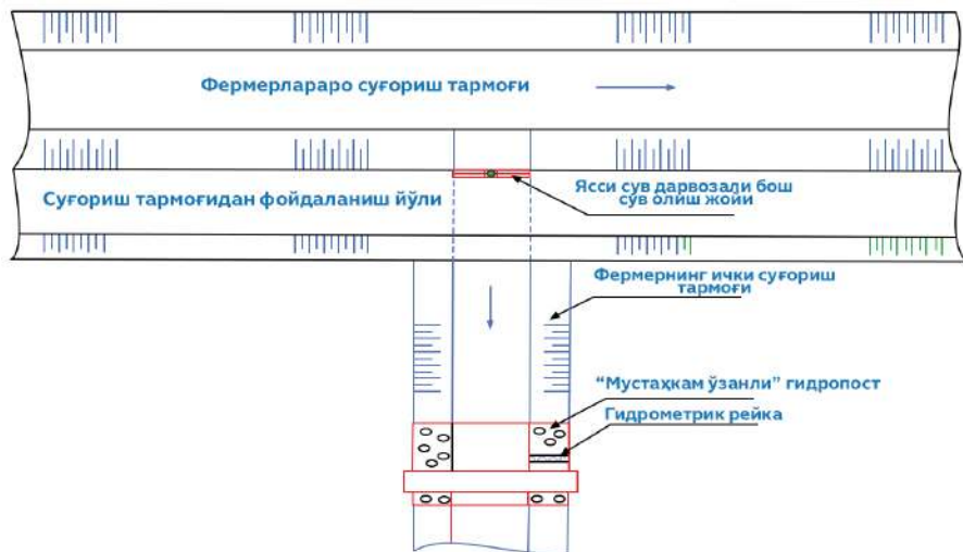
2.1-расм. Очиқ суғориш тармоғидаги сув олиш жойининг схемаси
