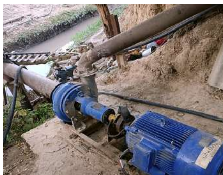
1.6-расм. Суғориш тармоғидан насос ёрдамида сув ҳисобини юритмасдан сув олиш
