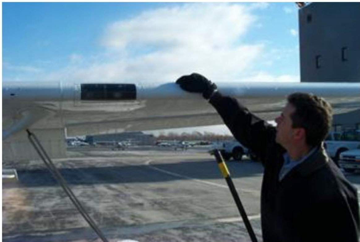
Рис. III-6-1. Проверка после применения противообледенительных жидкостей может быть чрезвычайно важна для обнаружения замерзших загрязнений
