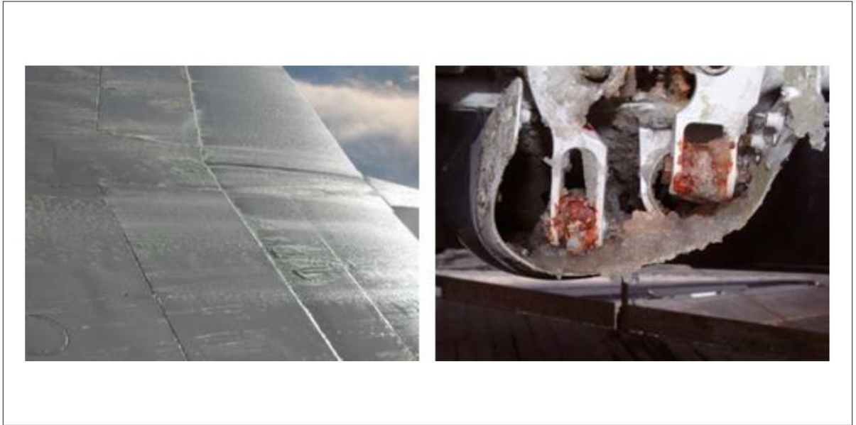
Рис. III-9-1. Остатки противообледенительной жидкости, замерзшие на крыле, а также высохшие и повторно набравшие влагу остатки жидкости на механизмах управления, способные вызвать ограничение движения
