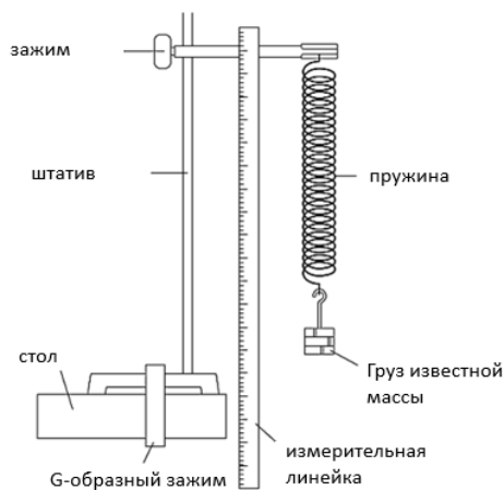
Устройство для определения жёсткости пружины
