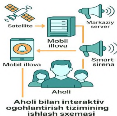
6-rasm. Aholi bilan interaktiv ogohlantirish tizimining ishlash sxemasi
