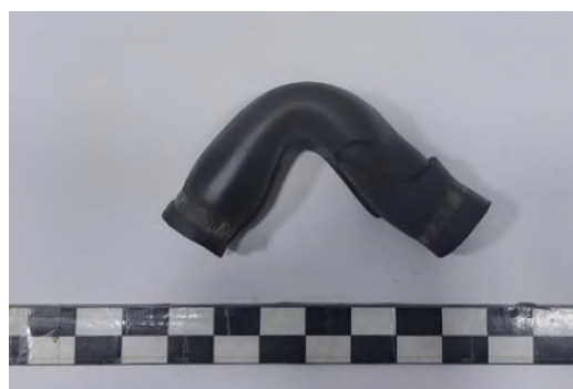
5-расм. “Hyundai Sonata” автомобилнинг мотор қисми ва совутиш суюқлик қувурлари
