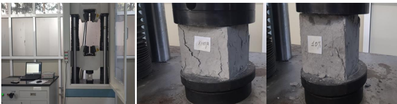
3-расм. МИГ.1000.06РУ гидравлик прессида волластонит минераллари қўшилган бетон намуналарининг синовлари
