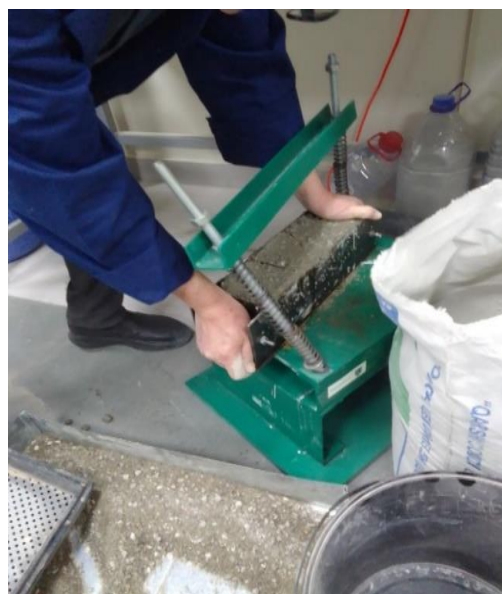
1-расм. Волластонит минерали қўшимчаси қўшилган бетон қурилиш материаллари намуналарини олиш жараёнлари
