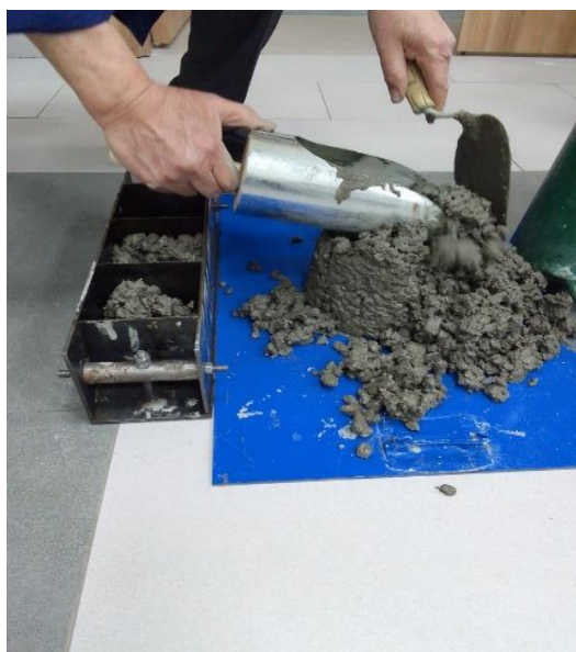
1-расм. Волластонит минерали қўшимчаси қўшилган бетон қурилиш материаллари намуналарини олиш жараёнлари
