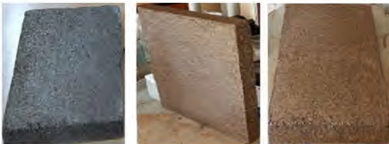
3-rasm. Issiqlik oʻtkazuvchanlik koeffitsiyentini aniqlash uchun tayyorlangan namuna
