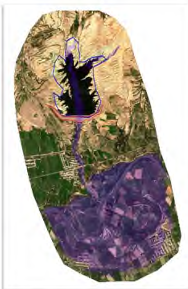
Рис. 3. Моделируемый поток в случае прорыва дамбы Резаксайского водохранилища
