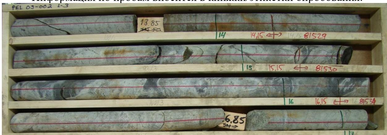
Рис. 9. Керн с размеченной линией распиловки
