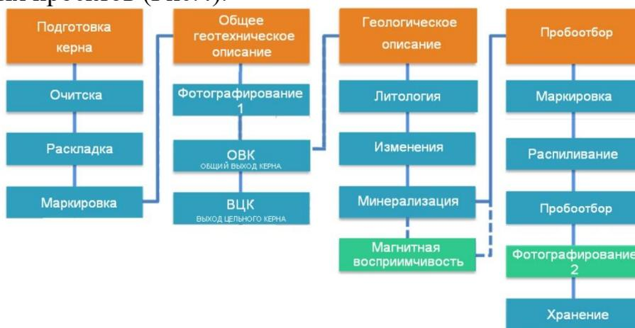
Рис. 4 Технологическая схема документации и обработки керна
