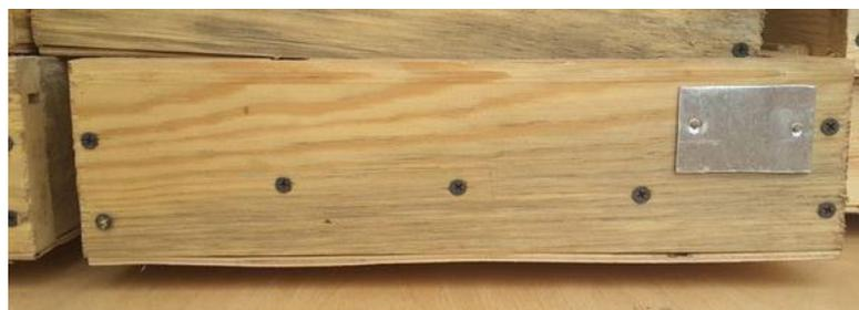
Рис. 2 Пример алюминиевой этикетки на торце ящика
